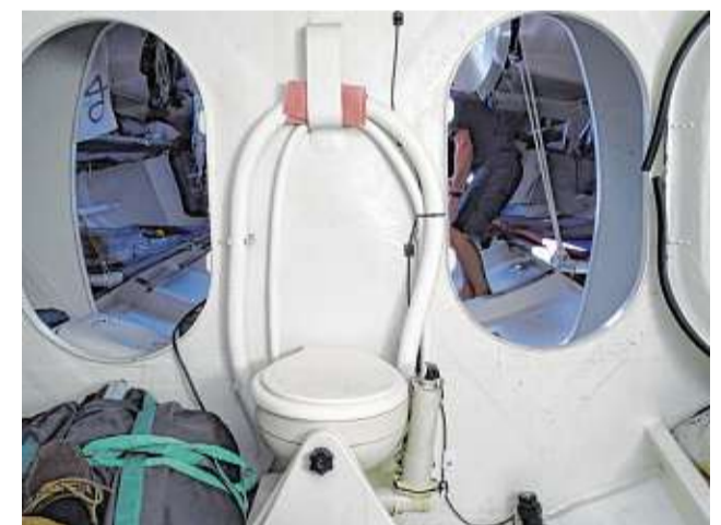
Eine der wichtigen Ausstattungen: Die Toilette lässt sich je nach Krängung des Bootes in die Senkrechte verstellen
